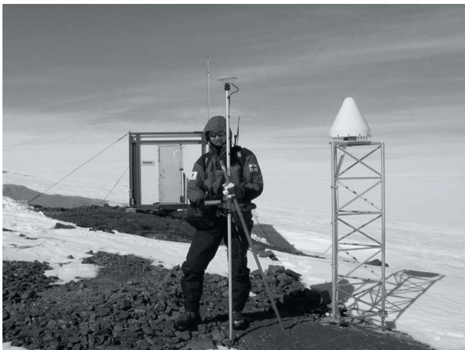
Kuva 3. Aboan pysyvä GPS-asema Basen-nunatakin rinteessä. GPS-vastaanotin on sijoitettu takana näkyvään konttiin, jonka sisällä olevalla pilarilla suoritetaan painovoimamittauksia. Kenttäkausien ajaksi kontin katolle asennetaan RTK-tukiaseman lähetyksiantenni. (Kuva: J. Ahola/FINNARP2003)
