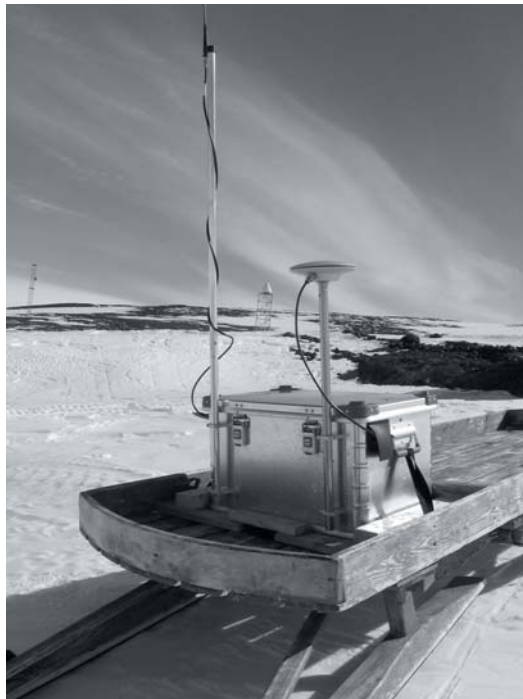
Kuva 8. Basenin rinteän profiileja mitattiin RTK GPS:llä. Kuvassa olevaa kelkkaa hinattiin moottorikelkalla mitaten koordinaatteja 1 m välein. (Kuva: J. Ahola/FINNARP2003)
