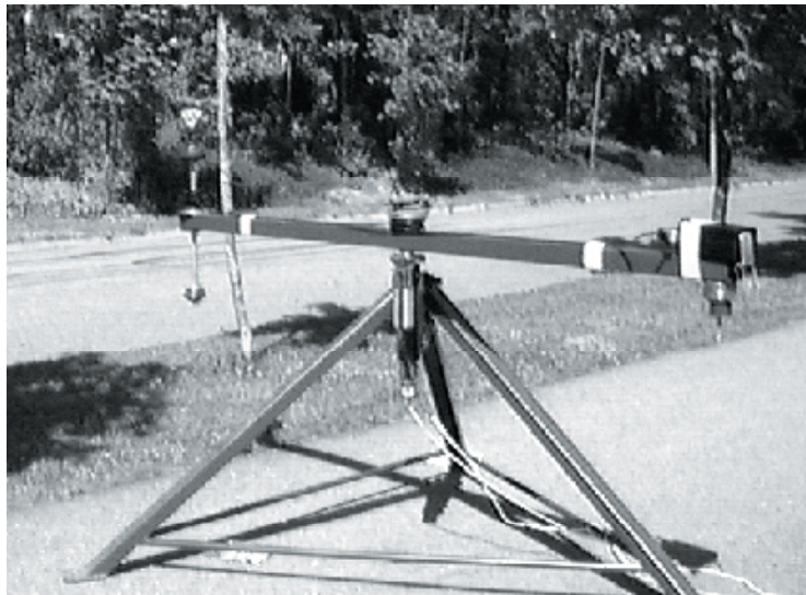
Kuva 1. Tarkkuustutkimuksissa käytetty ympyrätestirata. Tieto puomin kiertoasennosta saadaan pulssianturin avulla. Nopeutta voidaan säätää portaattomasti. Esimittauksilla rata sidotaan mittauskoordinaatistoon.
