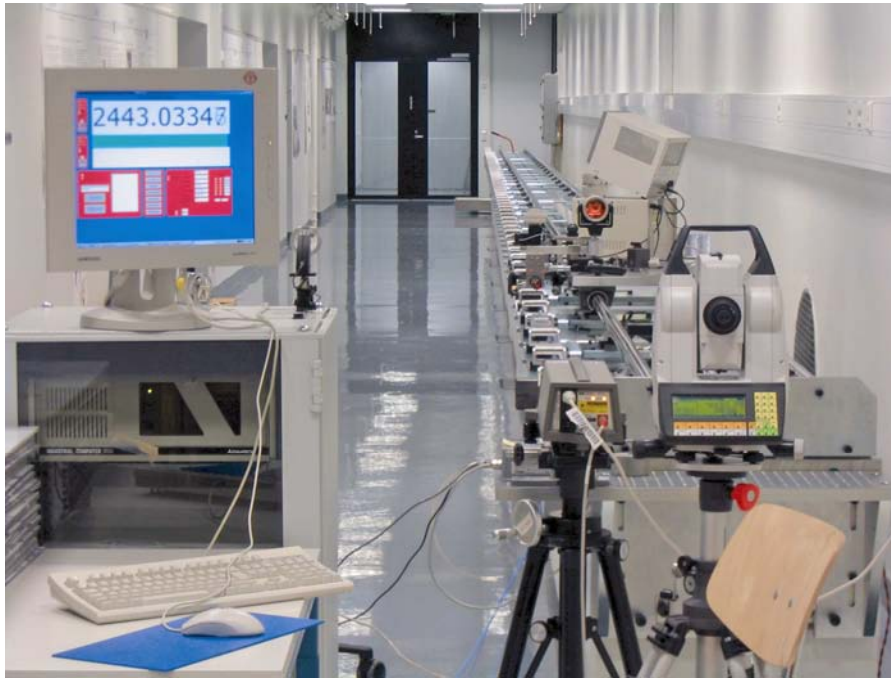
Kuva 3. MIKESin 30 metrin mittarata, jolla voidaan kalibroida esim. takymetrejä.
