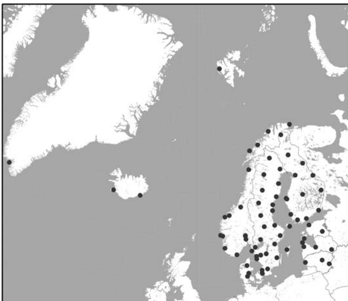
Kuva 1. Pohjoismaisen havaintojärjestelmän NGOS:n suunnitellut pisteet. Suurin osa on pysyviä GPS-asemia, joilla valtaosassa tehdään myös säännöllisiä painovoimahavaintoja absoluuttigravimetreilla.
