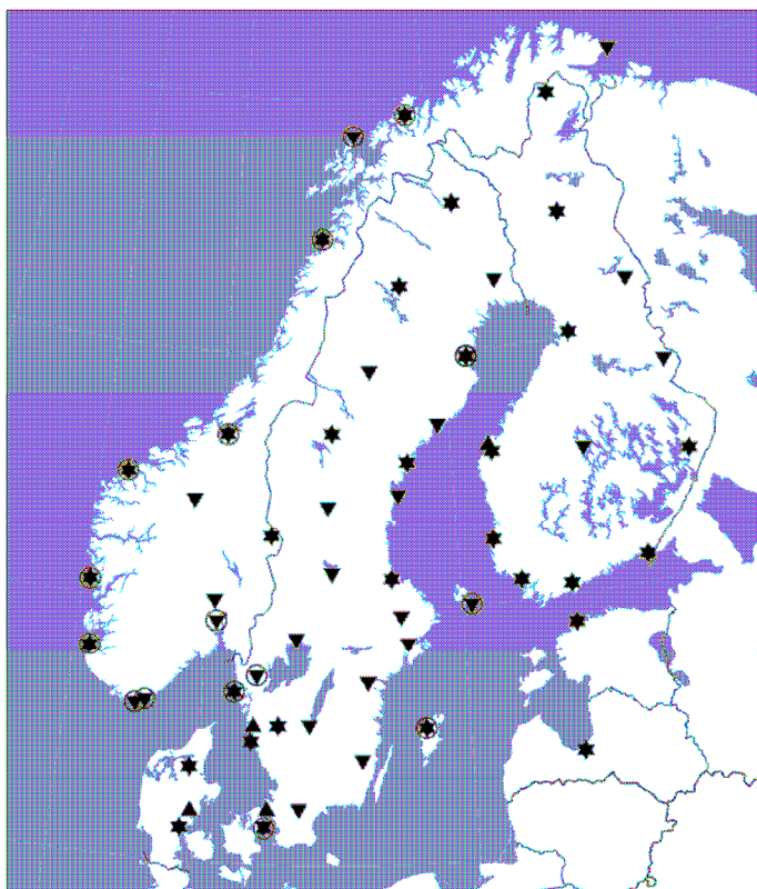
Kuva 2. Fennoskandian alueen NGOS-verkko. Ylösalaiset kolmiot tarkoittavat pysyviä GPS-asemia, tavalliset kolmiot absoluuttipainovoimapisteitä ja ympyrät mareografeja.
