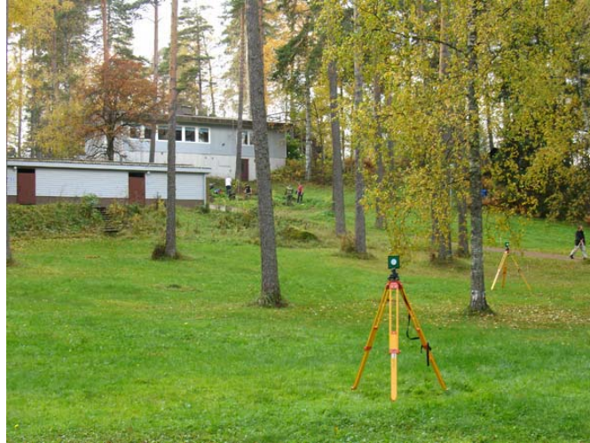
Kuva 2. Maastomallin mittausta Huhtiniemessä vuonna 2007. Kuvassa pistepilvien yhdistämiseen ja georeferointiin käytettäviä tasotähyksiä.
